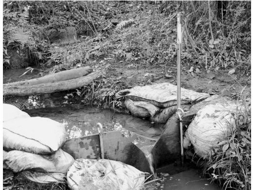
図3 観測装置の概要。左上が上流(湿地)側，右下が下流側で，右に立っているポールが水位計である。
