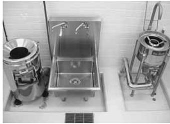
図10-2 下処理室：ピーラー(左), 洗米機(右)
